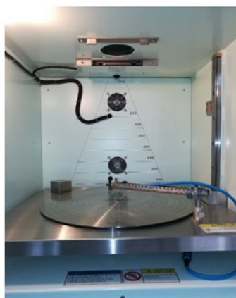
(b) Buồng chiếu xạ với bàn đặt mẫu và thang đo khoảng cách
