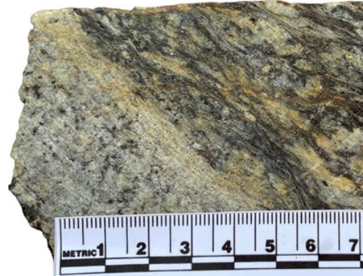
Ranh giới tiếp xúc giữa đá Granit phức hệ Sa Huỳnh và đá biến chất phức hệ Kannack
