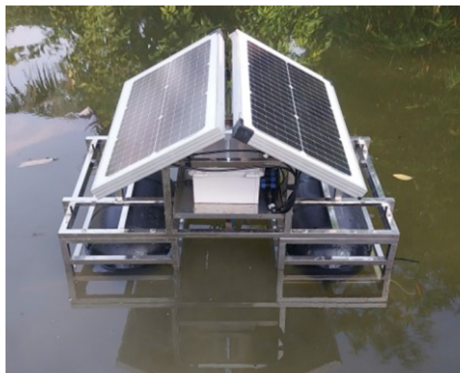
Thiết bị đo độ mặn nổi trên phao, sử dụng năng lượng mặt trời
