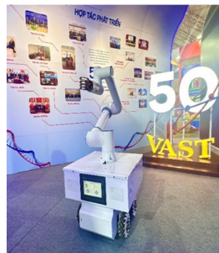
Sản phẩm của Đề tài bao gồm 2 robot tự hành gắn tay máy 6 bậc tự do và tủ điều khiển trung tâm
