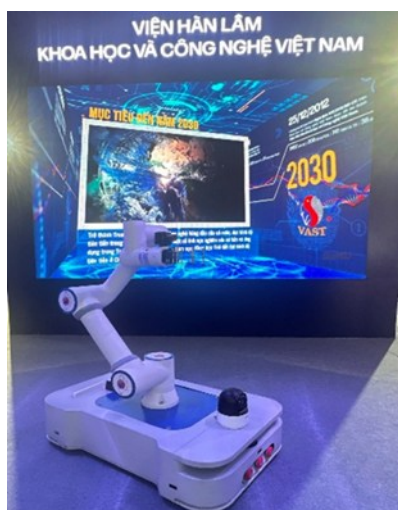
Sản phẩm của Đề tài bao gồm 2 robot tự hành gắn tay máy 6 bậc tự do và tủ điều khiển trung tâm
