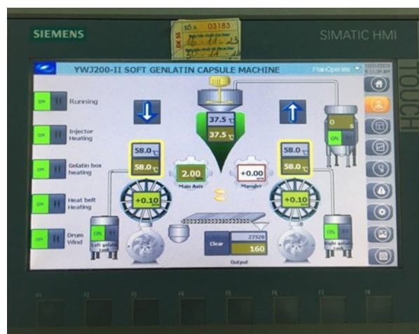
Máy tạo nang và bảng điều khiển tự động (Công ty cổ phần Dược liệu Việt Nam)
