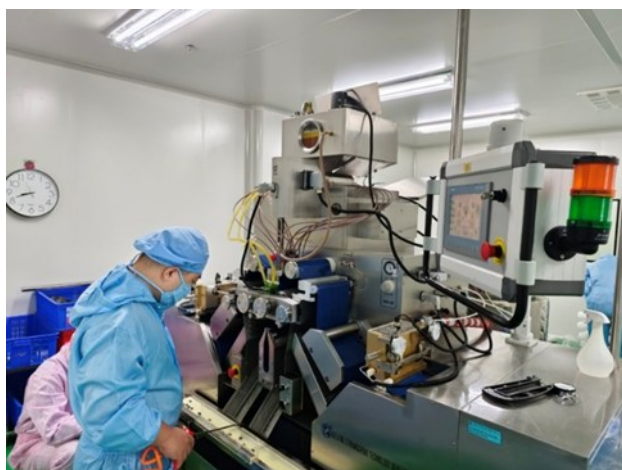
Máy tạo nang và bảng điều khiển tự động (Công ty cổ phần Dược liệu Việt Nam)
