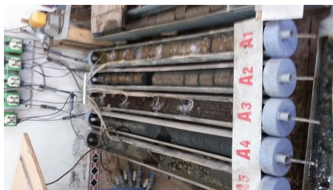
Hệ thực nghiệm đánh giá hoạt động của vi sinh vật trong vật liệu EBB
