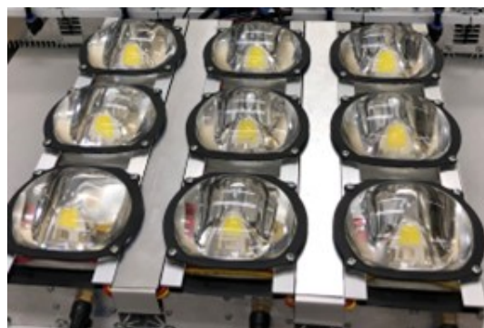
Thiết kế và đèn pha LED công suất 450W sử dụng trong thử nghiệm
