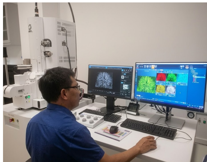
PGS.TS. Nguyễn Văn Chúc đo SEM mapping mẫu \text{TiO}_2/\text{graphene} cấu trúc lõi/vỏ trên hệ thiết bị Kính hiển vi phát điện tử quét phát xạ trường điện tử (FESEM, JSM-IT8000)
